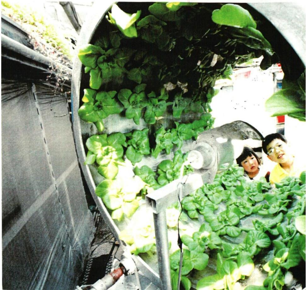
JAXA からの依頼でエム式水耕研究所が設計した球形の植物栽培装置
